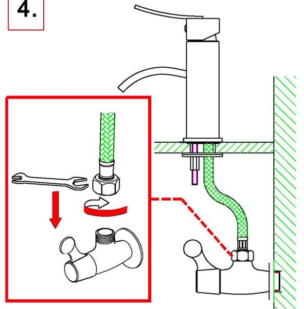
4. Schließen Sie die Wasserschläuche zu Eckventilen samt der Feindichtung an.
