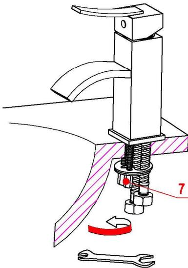
3. Nach Einstellung der Richtung des Hauptkörpers ziehen Sie Sechskantenmutter (7) mit einem Schlüssel an.
